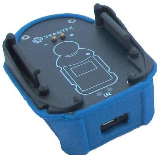
Док-станция SA 104-1 поддерживает одновременную зарядку аккумулятора и загрузку данных с дозиметра шума SV 104IS. Прибор расположен на базовой станции с системой держателей, обеспечивающей правильное положение для зарядки аккумулятора. SA 104-5 использует порт mini USB для зарядки аккумулятора и подключения к ПК. Загрузка данных осуществляется через инфракрасный интерфейс. Состояние батареи дозиметра отображается светодиодом LED, расположенным рядом с системой ручек.
