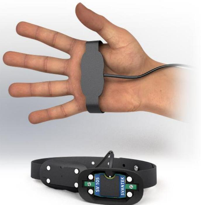
SV 105 — трёхкомпонентный, недорогой акселерометр, созданный на базе технологии [MEMS](#), предназначенный для измерения локальной вибрации, в соответствии с ГОСТ 31192.1,2–2004 (ИСО 5349–1,2: 2001). Особенность SV 105 в том, что датчик встроен внутрь адаптера специальной формы, который в свою очередь, легко устанавливается и крепится в ладони человека, работающего с ручным инструментом.
