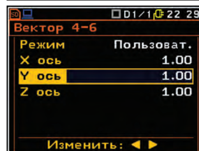
Выбор каналов и коэффициентов чувствительности при вычислении полной вибрации
