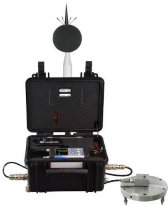
Новая станция мониторинга SV258PRO предназначена для измерения вибрации зданий с использованием методов, основанных на пиковой скорости частиц и доминирующей частоте. Возможно измерение человеческой вибрации в зданиях, поскольку программа позволяет одновременно измерять скорость и ускорение вибраций с двумя независимыми шагами записи. Кроме того, можно дополнить измерение результатами звука класса 1.
