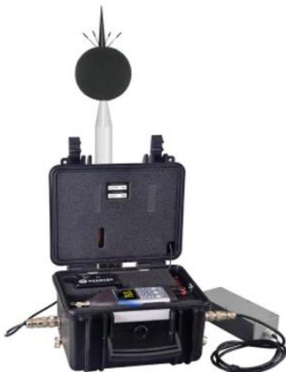
Станция мониторинга шума SV277PRO - это система наружного мониторинга, основанная на шумомере SVAN 977 Class 1. SVAN 977 легко вынимается из корпуса и используется в качестве портативного шумомера. ПЦН использует модем 4G для удаленной связи с Интернетом.
