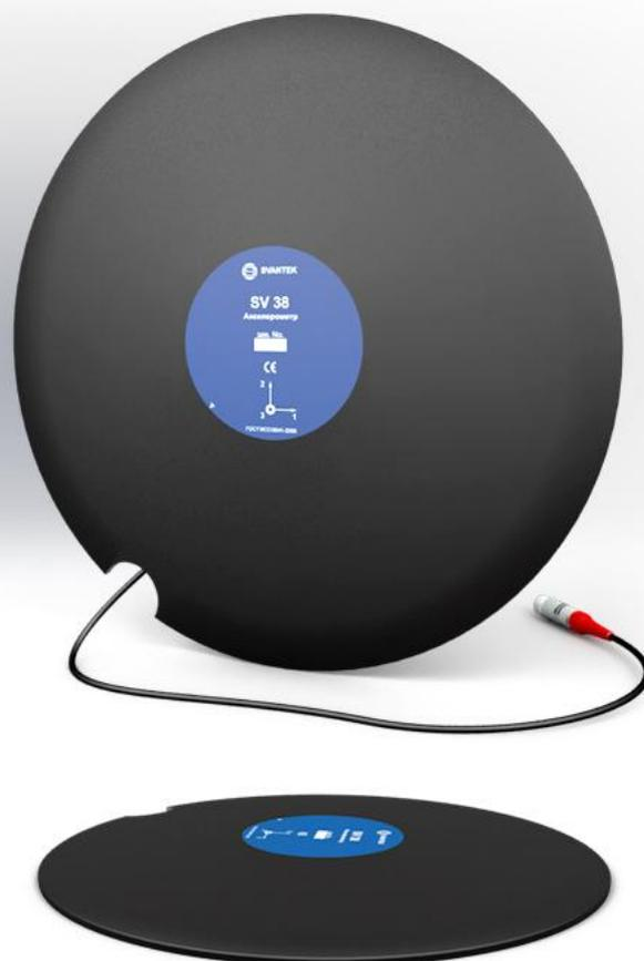
SV 38 — трёхкомпонентный недорогой акселерометр, созданный на базе технологии MEMS, предназначенный для измерения общей вибрации в соответствии с ГОСТ 31191.1, 2 -2004 (ИСО 2631–1:1997, ИСО 2631–2:2003). Особенность SV 38 в том, что датчик встроен внутрь полужёсткого резинового диска, который в свою очередь, легко устанавливается на сидениях транспортных средств и их спинках, а также на сидениях офисных кресел и даже на полу для измерения общей вибрации.
