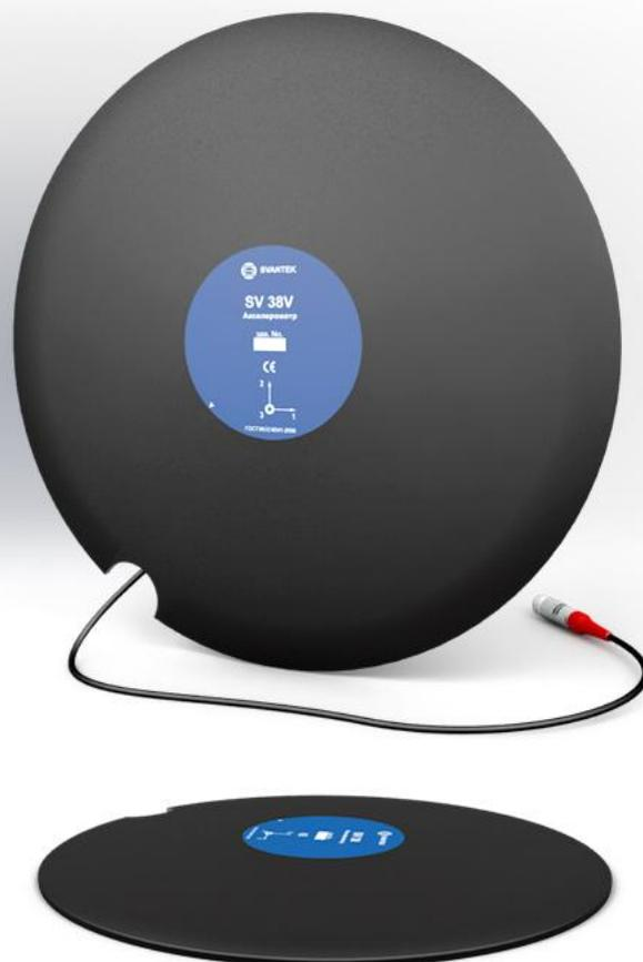
SV 38V — трёхкомпонентный недорогой акселерометр, созданный на базе технологии MEMS, предназначенный для измерения общей вибрации в соответствии с ГОСТ 31191.1, 2 -2004 (ИСО 2631–1:1997, ИСО 2631–2:2003). Особенность SV 38V в том, что датчик встроен внутрь полужёсткого резинового диска, который в свою очередь, легко устанавливается на сидениях транспортных средств и их спинках, а также на сидениях офисных кресел и даже на полу для измерения общей вибрации.
