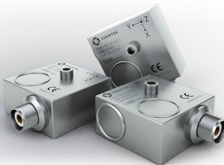
SV 84 — трёхкомпонентный, пьезоэлектрический акселерометр в герметичном корпусе, предназначенный для одновременного измерения вибрации по трём осям в жёстких промышленных условиях.
