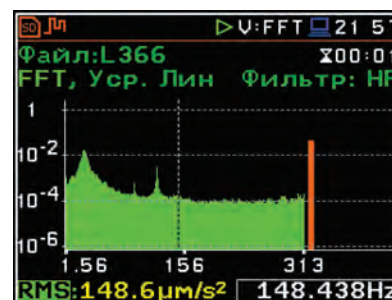
Результат измерения узкополосного спектра — БПФ
