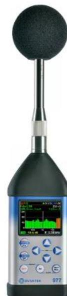
SVAN 977C также можно использовать в качестве измерителя уровня вибрации - просто подключив кабель и датчик вибрации.
