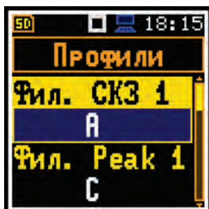
Настройка ПРОФИЛЯ 1, в соответствии с которой выполняется измерение ТЕКУЩЕГО SPL
