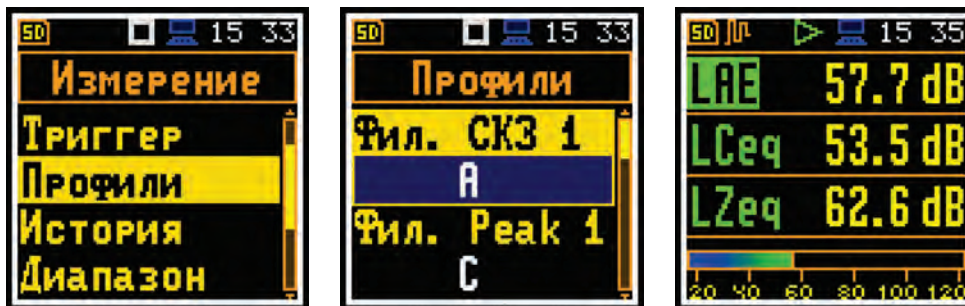
Настройка прибора в ПРОФИЛЯХ и вывод результатов измерений трёх ПРОФИЛЕЙ на дисплей прибора
