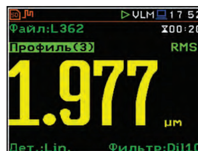
Измерение виброперемещения с применением фильтра Dil10
