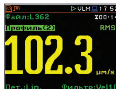
Измерение виброскорости с применением фильтра Vel10
